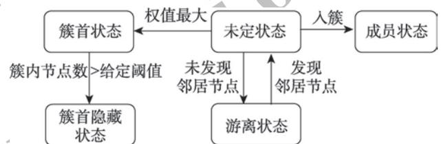
图2 节点状态转换图
